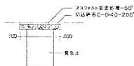
舗装復旧図 NO-SCALE (道路歩道部分)
