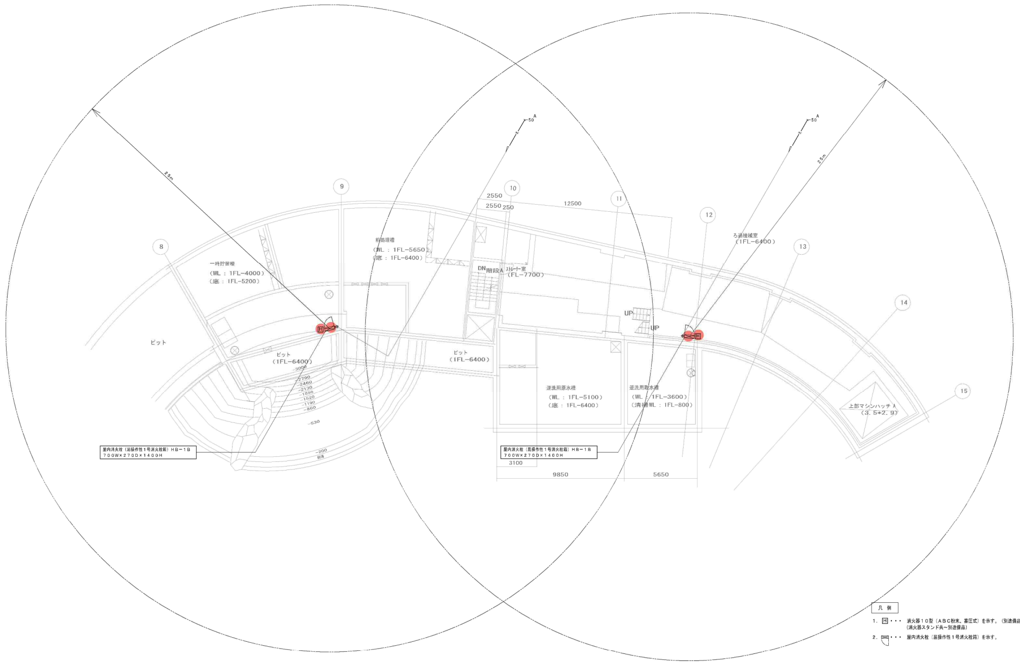
建物-42 ゾウ舎地階 (消火器・屋内消火栓)
