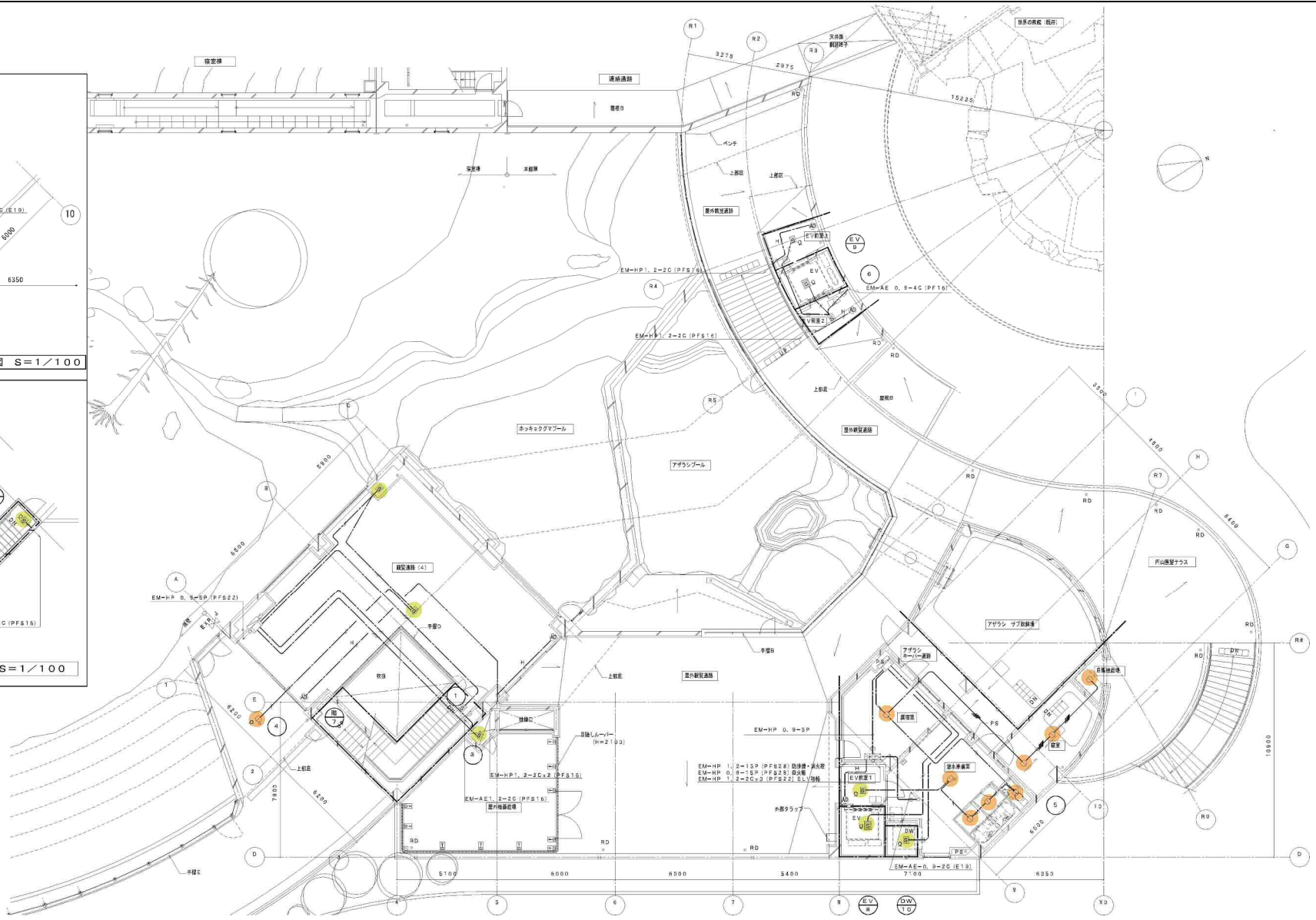
本館棟 2階 火災報知設備平面図 S=1/100
