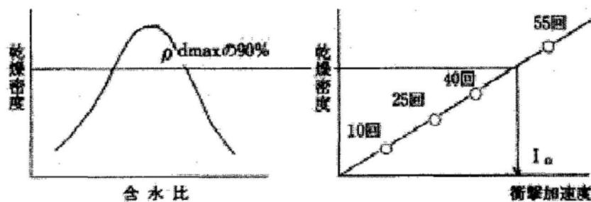
図-3 締固め試験によって明確な最大乾燥密度が得られる試料の基準となる衝撃加速度
