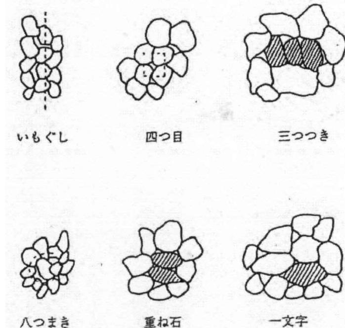
9. 受注者は、空積工は、胴かいにて積み石を固定し、胴込め、裏込めを充てんしつつ平たい大石を選んで尻がいを施して主要部を完全に支持し、その空隙は目つぶし砂利をもって十分堅固にしなければならない。
