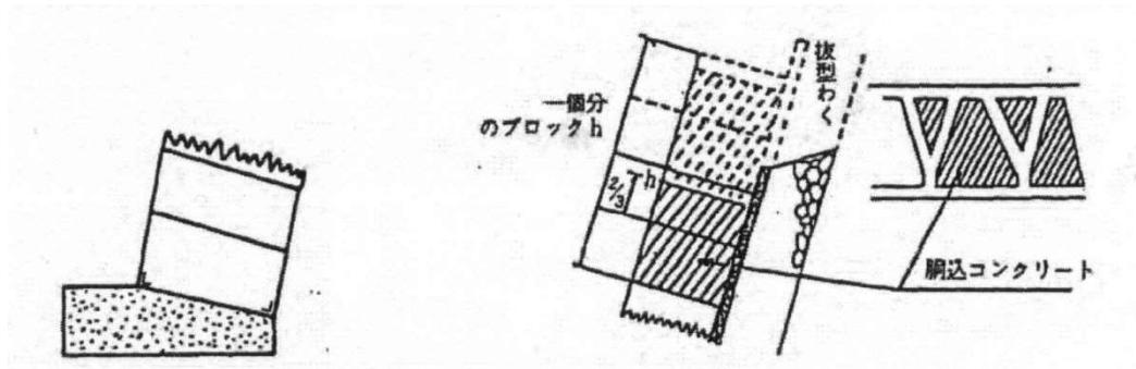
4. 受注者は、抜型わくは胴込コンクリート打設後十分に養生し、1／2ごとに引き抜き、コンクリートを打設しなければならない。
