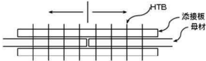
図 4-1 ボルト締め付け順序
