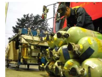
空気充てん設備
