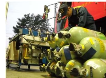
空気充填設備
