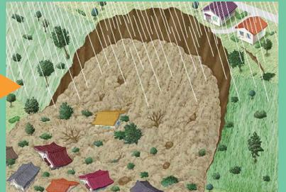
土砂災害警戒区域の指定基準 ①傾斜度が30度以上で高さが5m以上の区域 ②急傾斜地の上端から水平距離が10m以内の区域 ③急傾斜地の下端から急傾斜地の高さの2倍(50mを超える場合は50m)以内の区域
