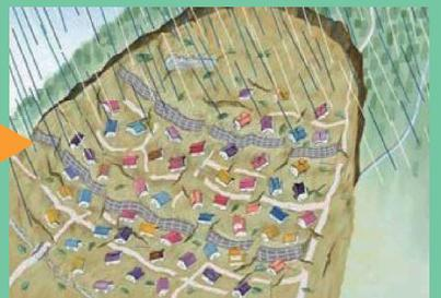
土砂災害警戒区域の指定基準 ①地滑りしている、又は地滑りするおそれのある区域 ②地滑り区域下端から、地滑り地塊の長さに対応する距離(250mを超える場合は250m)の範囲内の区域
