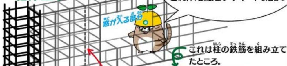
壁を作るには、はじめに「鉄筋」をきれいに組み立てるんだ。これが「鉄筋コンクリート」だよ。
