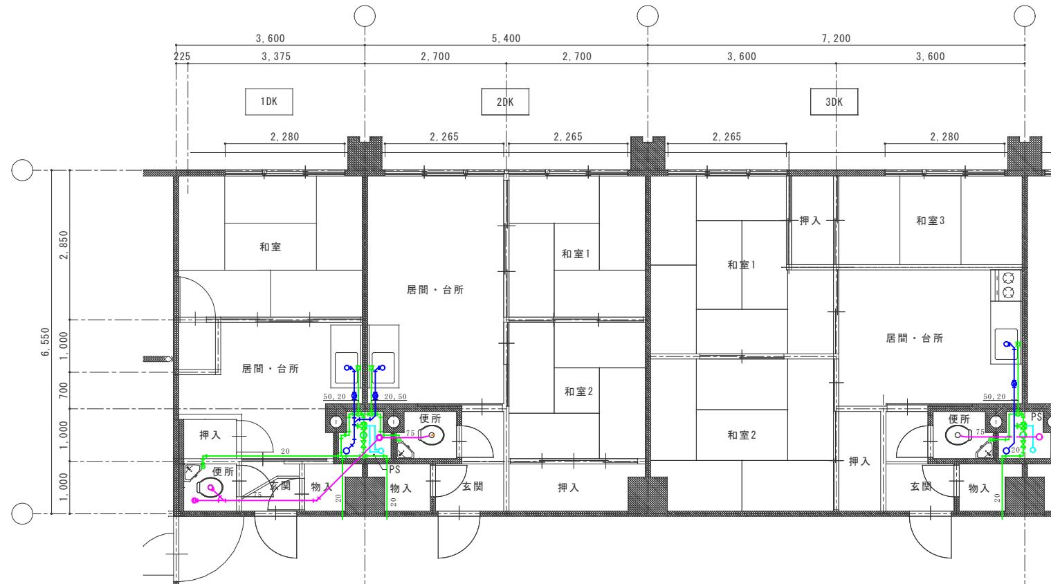
改修案 住戸給排水・給湯設備平面図
