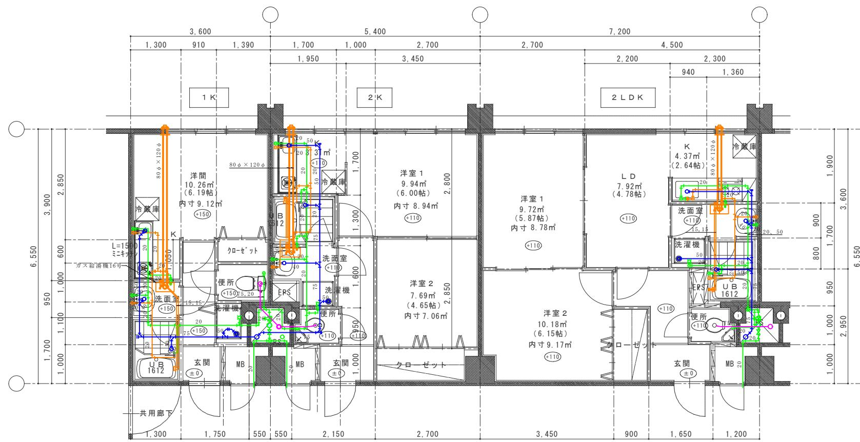
既存 住戸換気・給油設備平面図
