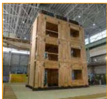
CLTを利用した建築物の実大振動台実験
