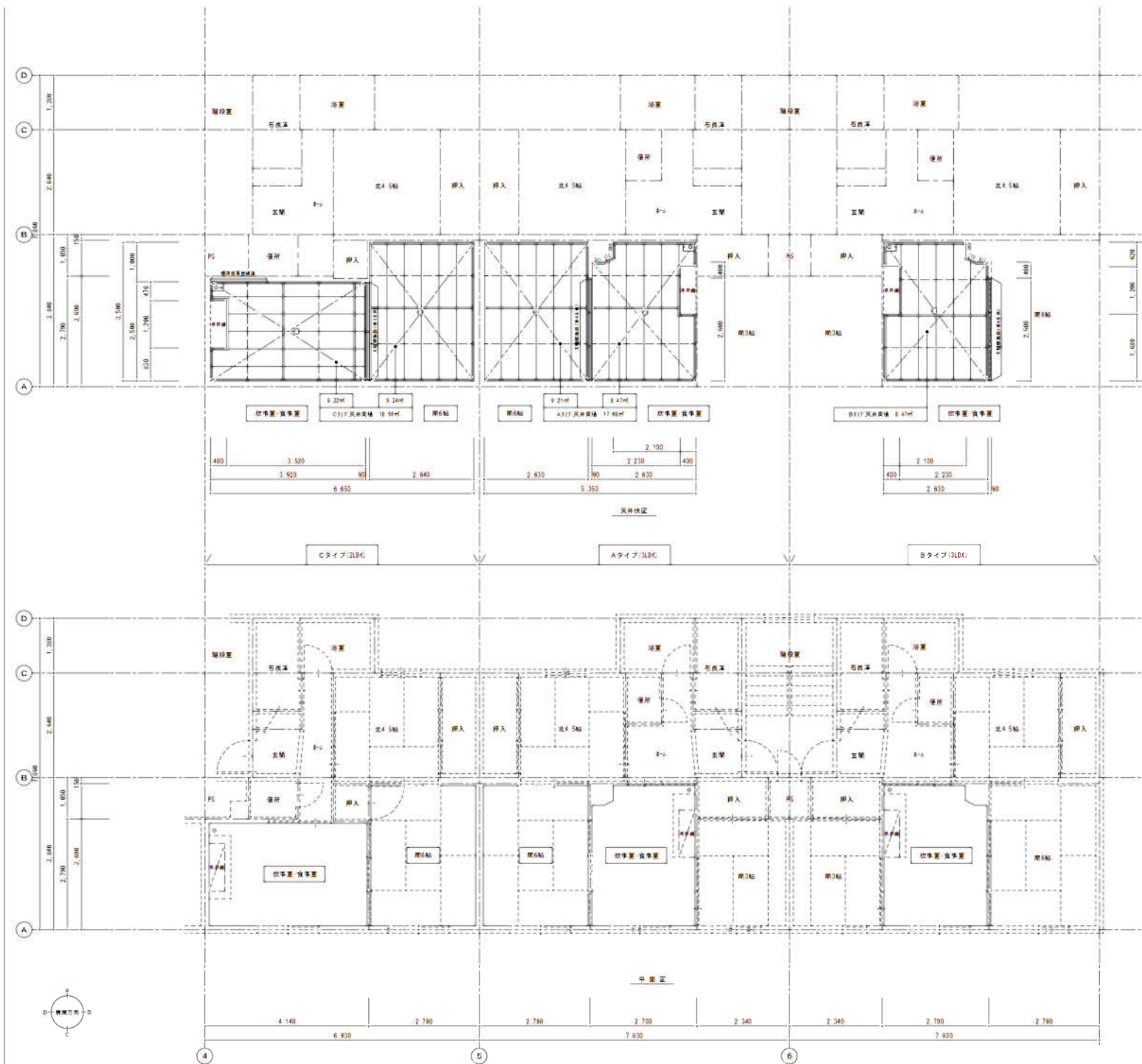
発寒団地16号棟2LDK・3LDK(A・B・Cタイプ)平面・天井伏図
