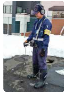
漏水探知器による調査
