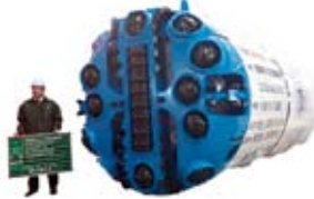
▲シールドマシンという機械を使ってトンネルを掘っていきます。
