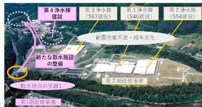
既存浄水棟の段階的な改修に伴い、改修時に不足する給水能力を補うため、新たに第4浄水棟を建設する。
