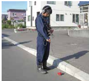
漏水探知器による調査
