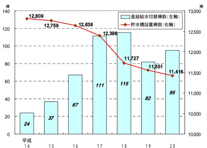
直結給水方式には、貯水槽水道と比較して、新鮮な水を飲むことができる、受水槽の設置スペースが不要になる、ポンプを動かすための電気料や水質検査費用などの維持管理費が不要になる、給水のために電気を使用しないので環境に優しい、などの優位性があります。
