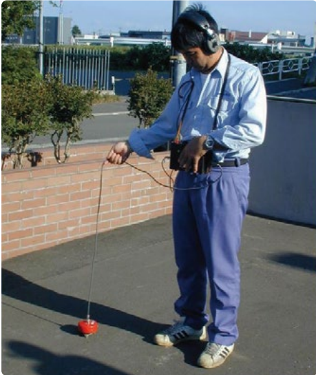
漏水探知機による調査
