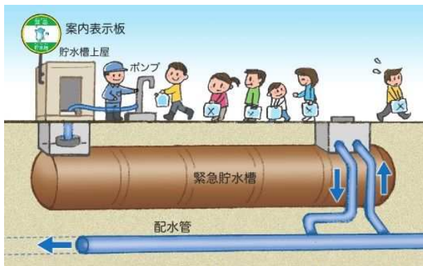
緊急貯水槽の整備
