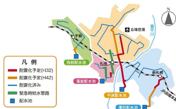
配水幹線連続耐震化事業
