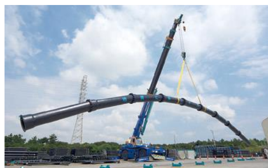
クレーンでつり上げても抜け出さない耐震管 （出典：一般社団法人日本ダクタイル鉄管協会）
