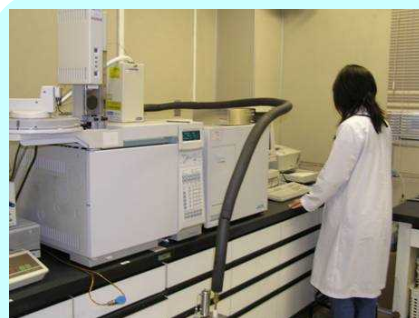
水質検査の例 (かび臭物質の機器分析)：GC/MS
