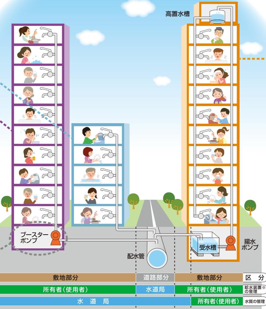
受水槽方式から直結方式への切替もできます。
