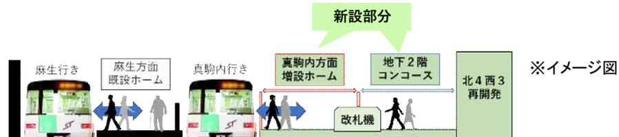
・現ホームを麻生方面専用、新ホームを真駒内方面専用とする。ホームにはエスカレーターを新設のうえ、新ホームには改札口を設置し、北4西3地区再開発建物と接続する。
