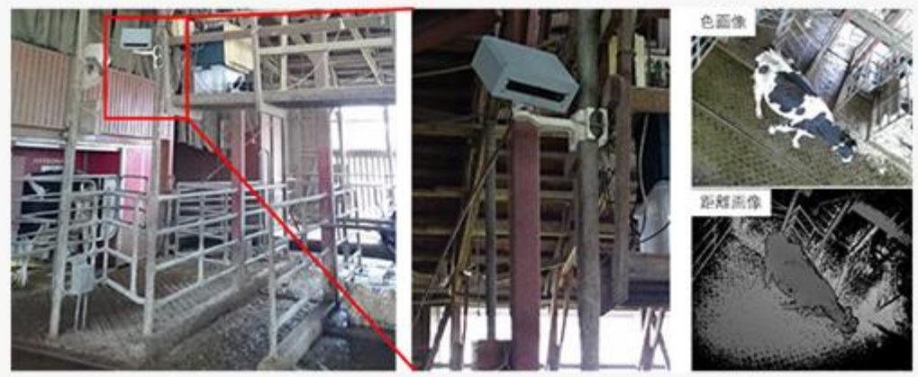
牛舎に設置された三次元形状計測用カメラと、撮影される画像例(出所:大阪大学産業科学研究所プレスリリース)
