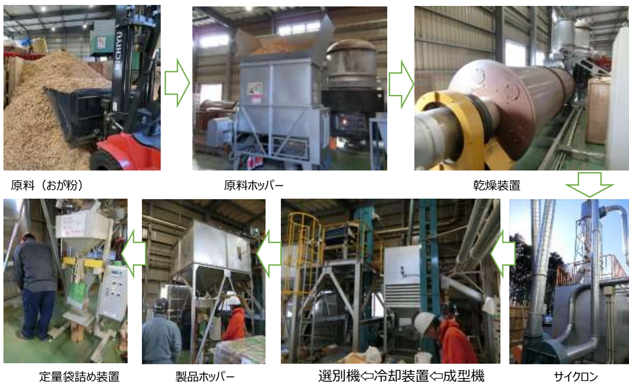
写真 b-1 カタログハウス社プラント・ペレット製造工程
