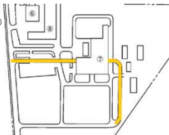
図 a-4 資源化工場への傾斜スロープのロードヒーティング（黄色）
