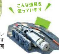
狭い管路を調査するテレビカメラ車。先端の回転するライトとカメラで、周囲を360度確認できます。
