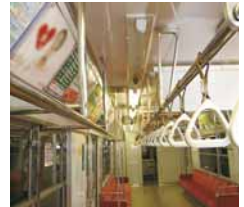
運行に支障のない範囲で、1車両当たり6本程度の照明の間引きをする。
