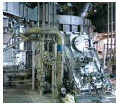
灰溶融炉。工場が発電した電気で動くため、停止すると余剰電力を北海道電力に売却できる。
