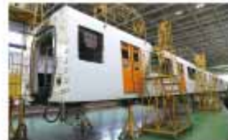
▲4年に一度、車両を分解して各装置を念入りに検査
