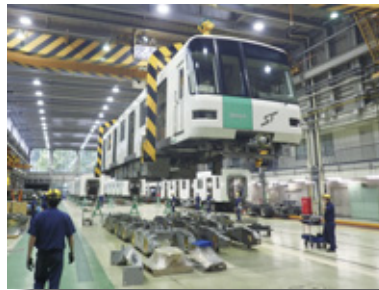
クレーンによる車体乗せ作業
