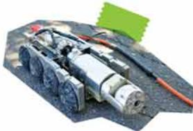
狭い管路を調査するテレビカメラ車。先端の回転するライトとカメラで、周囲を360度確認できます。
