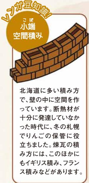
北海道に多い積み方で、壁の中に空間を作っています。断熱材が十分に発達していなかった時代に、冬の札幌でりんごの保管に役立ちました。煉瓦の積み方には、このほかにもイギリス積み、フランス積みなどがあります。
