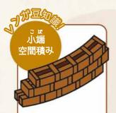
北海道に多い積み方 で、壁の中に空間を作 っています。断熱材が 十分に発達していなか った時代に、冬の札幌 でりんごの保管に役 立ちました。煉瓦の積 み方には、このほかに もイギリス積み、フラン ス積みなどがあります。
