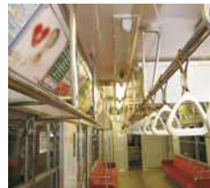
運行に支障のない範囲で、1車両あたり6本程度の照明の間引きをする。
