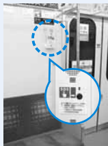
非常通報ボタン
