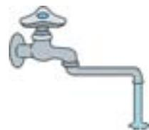
水道管の凍結を防ぐには、お休み時やお出掛け前に管の中の水を抜くことが大切です。水道局職員が実物大の水道管の模型を使って水抜きの方法を分かりやすく説明します。
