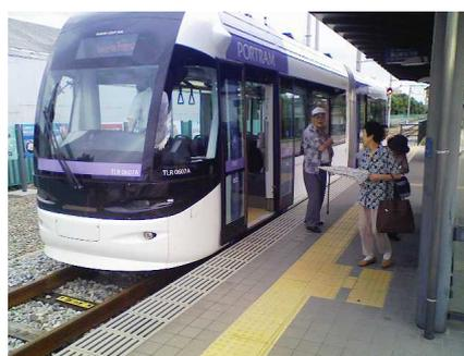
路面電車の低床車両(富山市の例)
