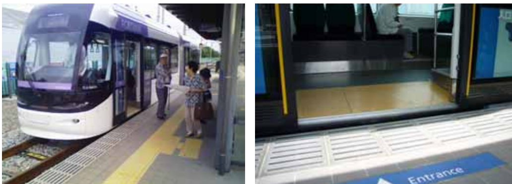
路面電車の低床車両導入（富山市）
