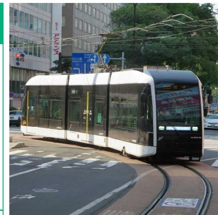
路面電車の低床車両の導入
