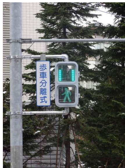
図 4-64 青時間の経過時間を表示する機能を有する信号機
