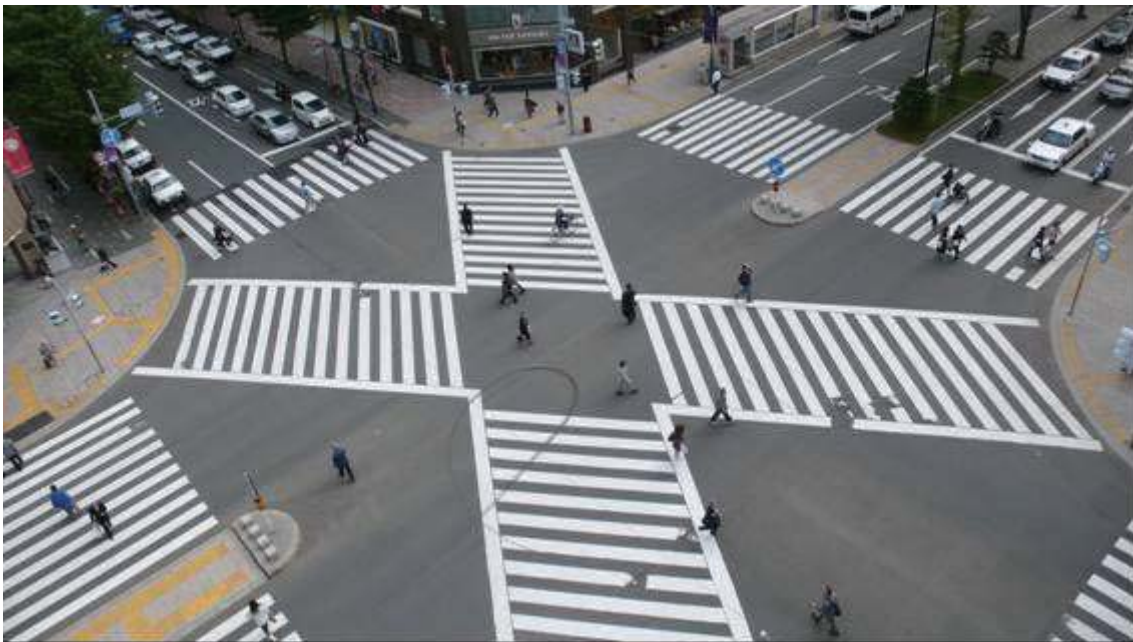
図 1-32 歩車分離式信号機（スクランブル交差点の例）
