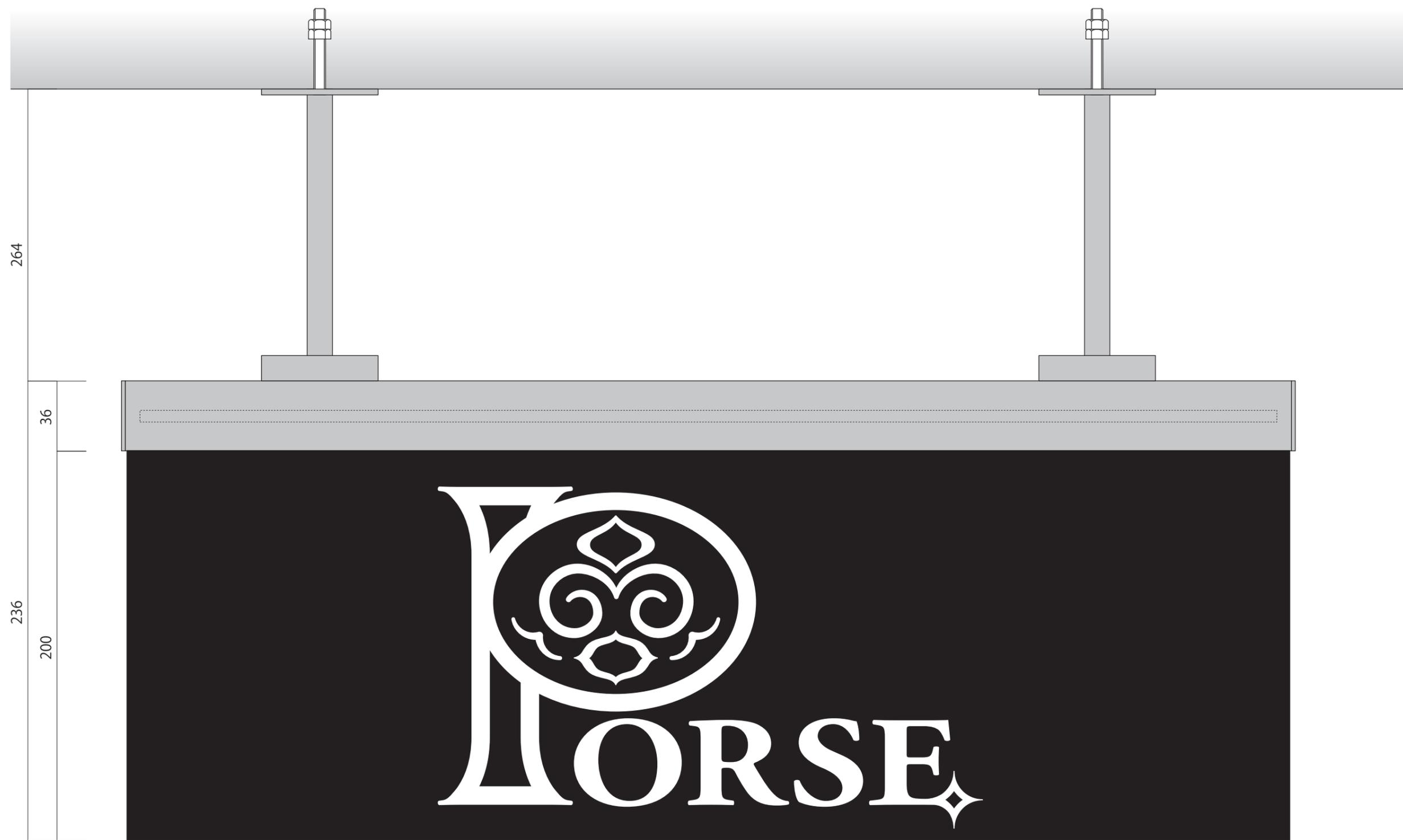
●サインパネル寸法 (W600×H200) scale:1/2 (A3出力)
