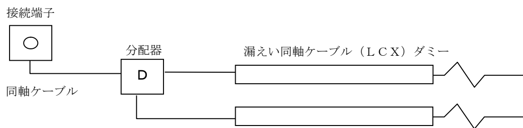
第23-2図 漏えい同軸ケーブル方式
