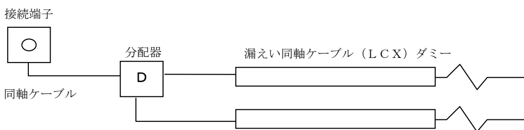
第23-2図 漏えい同軸ケーブル方式
