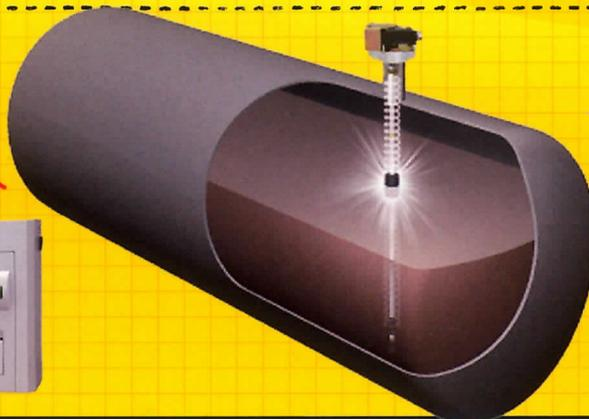
埋設されたタンクに貯蔵している危険物の液面を常に計測して、危険物の流出による液面の変化を検知し、警報を発するものがあります。
