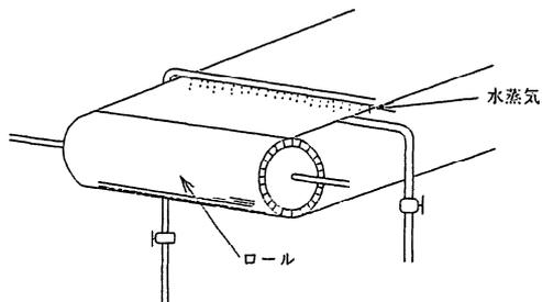
(蒸気噴射法の例)
