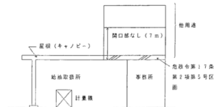
第13-37図 給油取扱所の屋根部分を不燃材料とすることができる例
