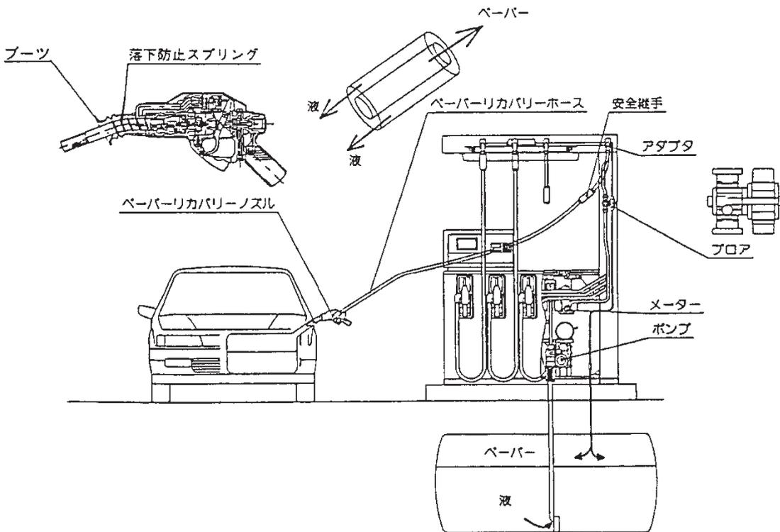
(送油管及び蒸気回収管に取り付けられたフロアが自動的に働き、蒸気を回収するもの。)
