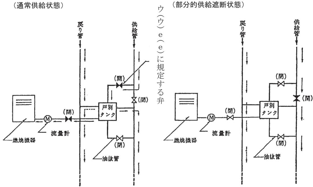
第15-33図 燃料供給系統詳細図 (系統例1)
