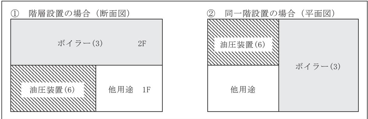
第15-2-4図 異なる取扱形態のものを2施設として設置した例
