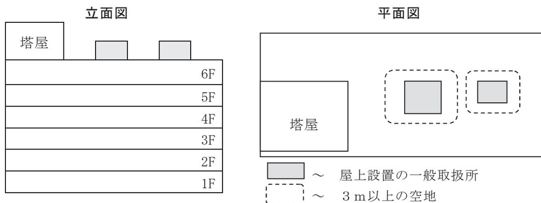
第15-41図 屋上に設置する一般取扱所の設置例（複数）
