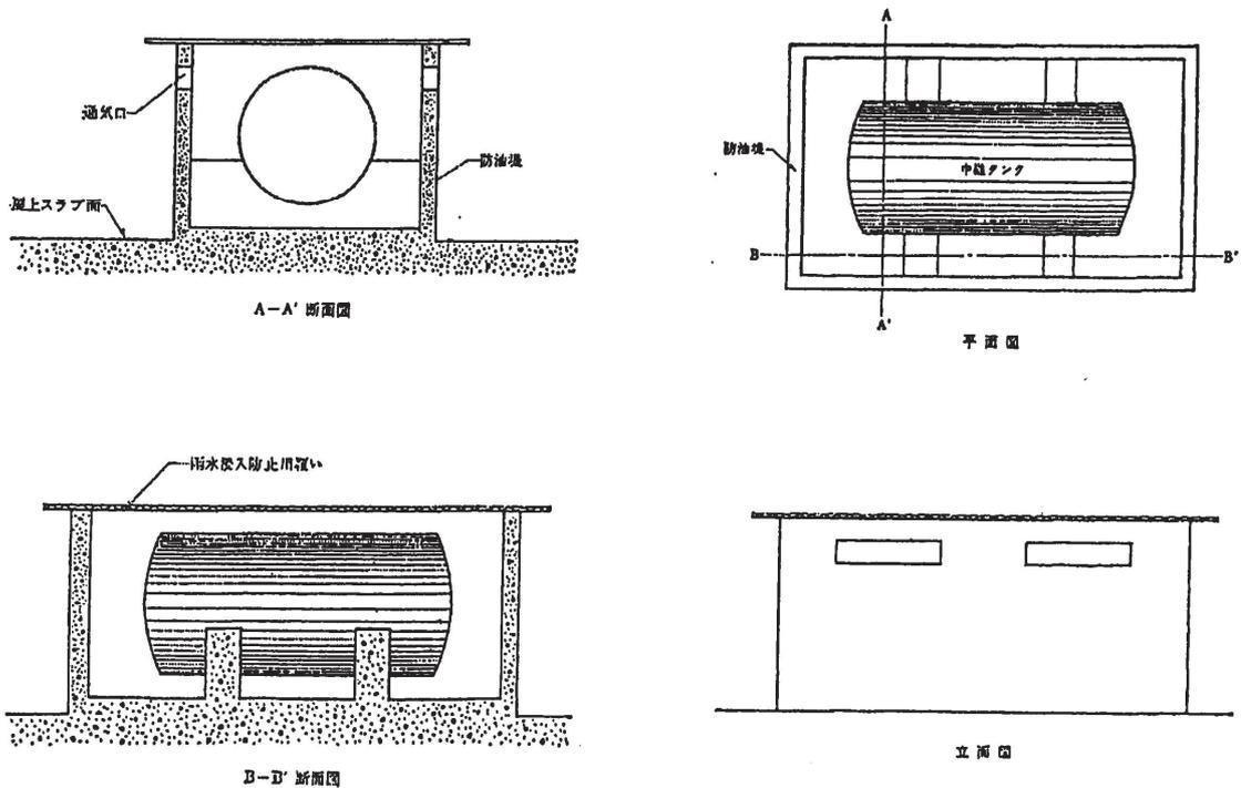
第15-32図 中継タンクの防油堤概略図
