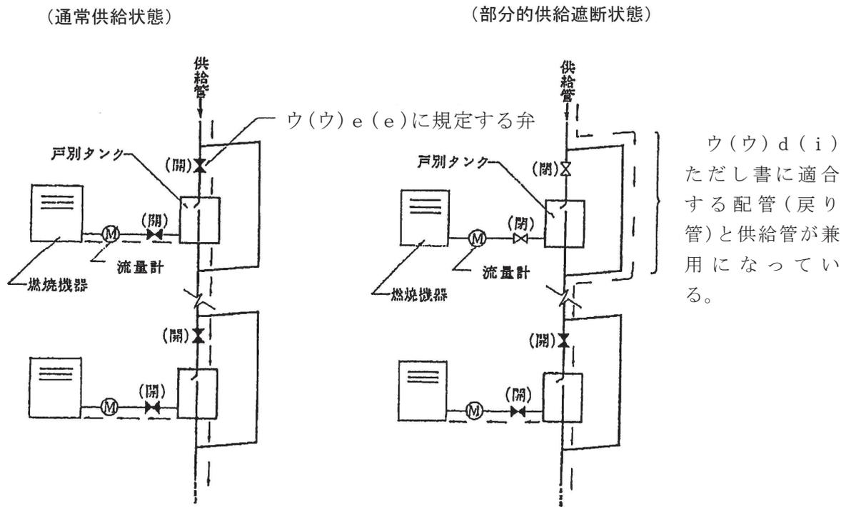
第15-34図 燃料供給系統詳細図 (系統例2)
