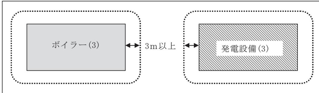
第15-3-3図 同じ取扱形態を設備単位の2施設として設置した例
