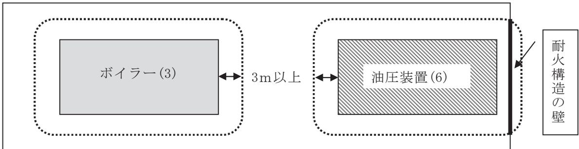
※ 周囲の空地内に建築物の壁及び柱がある場合は、当該壁及び柱が耐火構造であり、壁に出入口以外の開口部がないこと（出入口は、随時開けることができる自動閉鎖の特定防火設備であること。）。
