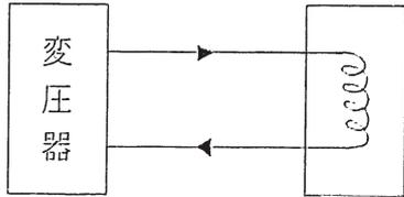
第15-27図 油を冷却するための設備の例
