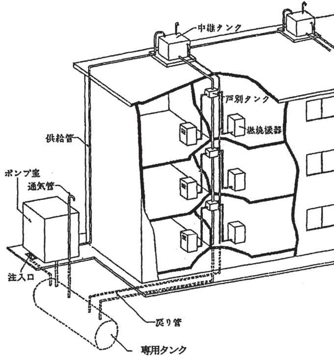
第15-29図 中継タンクを有する方式
