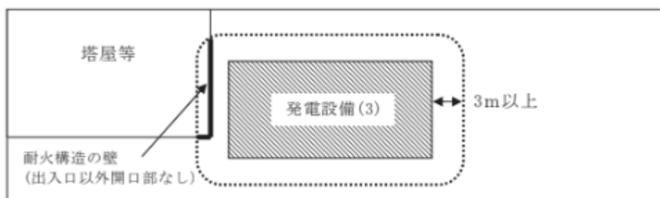
第15-4-3 図 保有空地内に出入口以外の開口部のない耐火構造の壁がある例
